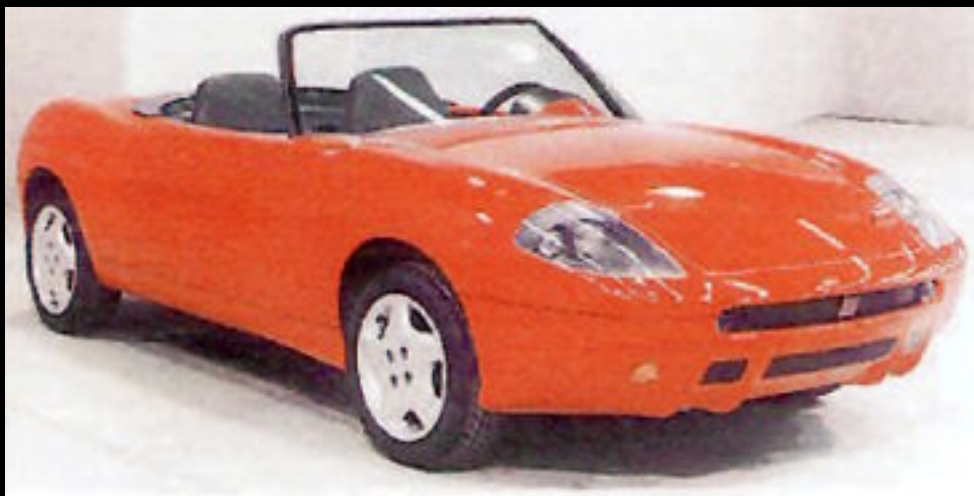
The second clay model of the Marinara , with the altered traffic lanterns in front and behind the well-known square-lanterns Das zweite Tonmodell der Marinara mit modifizierten Frontscheinwerfern und den bekannten eckigen Rückleuchten
