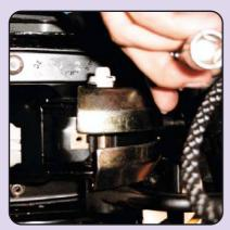
Um eine seperate Demonatge des Fahrer-Airbags zu vermeiden, habe ich die komplette Lekradeinheit samt beweglicher Lenksäule gelöst (vier Schrauben von unten zu erreichen) und das Lenkrad erstmal im Fußraum abgelegt.
