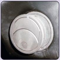
Dann die seitlichen Lüftungsdüsen ausbauen. Vorsichtig mit einem Schraubenzieher zwischen inneren und äußeren Ring den inneren heraushebeln. Dann die drei Schnappverschlüsse des äußeren Rohrs aufbiegen und das Rohr entfernen. Eine wichtige Haltemutter des Cockpits sitzt schäg oben ziemlich versteckt.
