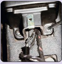
Es folgt dfie Demontage des Mittelbereichs. Da muss auch alles weg. Die ersten Schrauben sind in der Mittelablage. Die entfernen (Zigarettenanzünder abklemmen). Als nächstes Schrauben im Fußbereich der Mittelverkleidung entfernen. Dann die großen Imbuss-Schrauben der Handbremse entfernen. Am besten die
