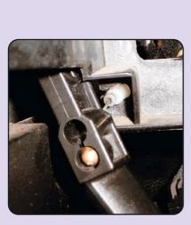
Die Motorhaubenentriegelung muss natürlich auch noch weg. Einfach die Halteschraube lösen und seitlich aus der Halterung drücken
