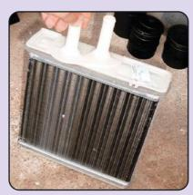
Alter Wärmetauscher raus neuer rein - fertig!
