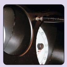
Es folgt die Demontage der Armaturen und das Enfernen der Lenkeinheit. Zunächst das untere Verkleidungteil des Lenkrads entfernen. Dann das obere (zwei versteckte Schrauben von unten zu erreichen.
