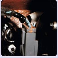
Als nächstes sollten die Anschlüsse des Heizungskastens mit dem Lüftersystem entfernt werden.
