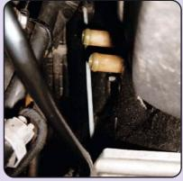
Natürlich wird der Wärmetauscher auch vom Motor her mit Kühlwasser versorgt. Der Anschluß ist mittig deutlich zu sehen. Die beiden Schlauchschellen abziehen und die große Haltemutter der Heizkörpereinheit (rechts daneben) lösen. Dann die drei Schrauben der Dichtungsmatte entfernen. Das wars im Motorraum.
